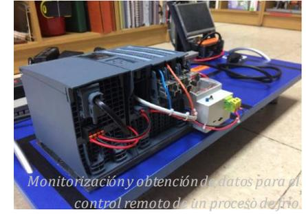
Monitorización y obtención de datos para el control remoto de un proceso de frío.
